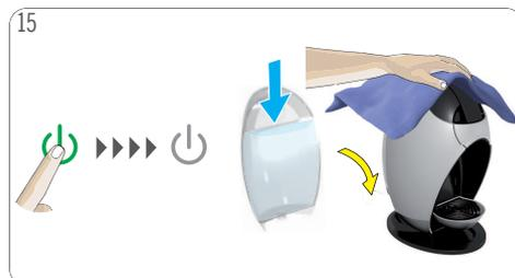
Apague la máquina. Enjuague y limpie el depósito de agua. Llene el depósito con agua potable fresca. Insértelo de nuevo en la máquina. Limpie la máquina con un paño húmedo y suave. Séquela después con un paño seco y suave.
