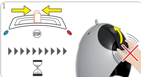
¡Mantenga siempre la máquina vertical! Para detener la preparación, mueva la palanca de selección a la posición "ALTO". No abra la manija de bloqueo ejerciendo fuerza. La máquina libera presión. Espere durante 20 minutos para reducir la presión.
