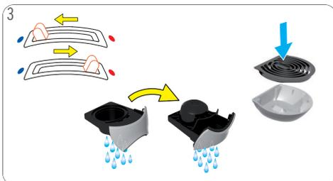
Enjuague la máquina: Siga las instrucciones de 5. «PRIMERAPUESTA EN FUNCIONAMIENTO» en la página 8. Limpie con líquido detergente y agua potable fresca ambos lados del soporte de la cápsula. Enjuague la bandeja de goteo con agua potable fresca y límpiela con un cepillo limpio adecuado para alimentos.
