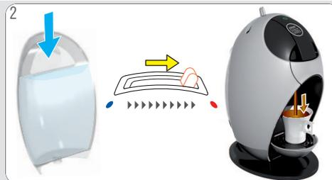
Compruebe si el depósito de agua contiene suficiente agua potable fresca. Si no es así, rellénelo con agua potable fresca y mueva la palanca de selección a la posición "CALIENTE" o "FRÍA" para seguir con la preparación. Si el depósito de agua está lleno, proceda como se describe en 9.2 «NO SALE LÍQUIDO – ¿CÁPSULA/INYECTOR BLOQUEADA/O?» en la página 15.
