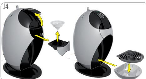
Abra la manija de bloqueo. Extraiga el soporte de la cápsula. Retire la herramienta de enjuague. Enjuague el soporte de la cápsula con agua potable fresca por ambos lados. Vuelva a insertar el porta cápsulas. Vacíe y limpie el recipiente. Coloque la rejilla de goteo sobre la bandeja de goteo. Luego inserte la bandeja de goteo en la posición deseada.
