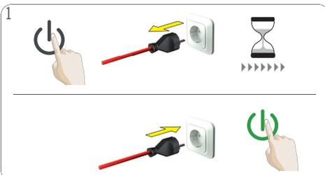
1 Apague la máquina. Compruebe que la cápsula no esté bloqueada, vea 9.2 «NO SALE LÍQUIDO – ¿CAPSULA/INYECTOR BLOQUEADO?» en la página 15. Retire el enchufe de alimentación y espere 20 minutos. Transcurrido este tiempo, inserte el enchufe en la toma de corriente y encienda la máquina.
