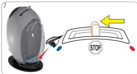
Compruebe visualmente cuando el depósito de agua esté vacío. Mueva la palanca de selección a la posición "ALTO".
