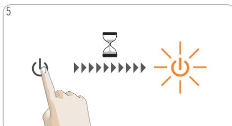
5 Pulse y mantenga pulsado el botón de encendido durante al menos 5 segundos. El botón de encendido empieza a parpadear en naranja. La máquina entra en el modo de descalcificación.
