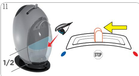
Compruebe visualmente cuando el depósito de agua esté a la mitad. (Snippet manquant ou snippet non valide) Mueva la palanca de selección a la posición "ALTO".
