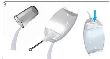
Vacíe y limpie el recipiente. Enjuague y limpie el depósito de agua. Use un cepillo limpio adecuado para alimentos y detergente líquido según sea necesario. A continuación, rellene el depósito de agua con agua potable fresca e insértelo en la máquina.
