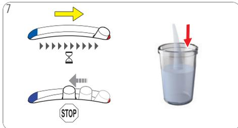
Mueva la palanca de selección a la posición "CALIENTE". La máquina se descalcifica en funcionamiento de inicio-alto durante aproximadamente 2 minutos. Cuidado, el líquido salpica al salir.
