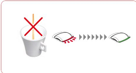
No sale líquido: La preparación de bebida se detiene parcialmente durante la preparación o no llega a iniciarse. El display de volumen parpadea y la luz indicadora parpadea en rojo y verde rápidamente.
