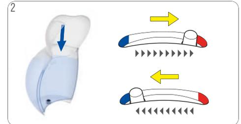
Compruebe si el depósito de agua contiene suficiente agua potable fresca. Si no es así, rellénelo con agua potable fresca y mueva la palanca de selección a la posición "CALIENTE" o "FRÍA" para seguir con la preparación. Si el depósito de agua está lleno, proceda como se describe en «NO SALE LÍQUIDO – ¿CÁPSULA / INYECTOR BLOQUEADO?» ver página 17.
