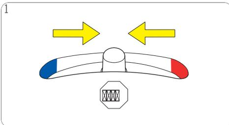
1 ¡Mantenga siempre la máquina vertical! Para detener la preparación, mueva la palanca de selección a la posición "ALTO".
