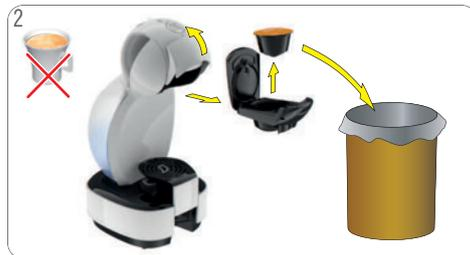
2 No beba el café. Levante la manija de bloqueo. La máquina libera presión. Retire el soporte de la cápsula. Abra el soporte de la cápsula. Tire la cápsula.
