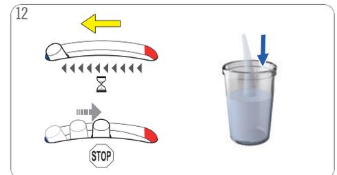
Empuje la palanca de selección a la posición "FRÍA". Espere hasta que la palanca se desplace a la posición "ALTO". El flujo de agua se para.
